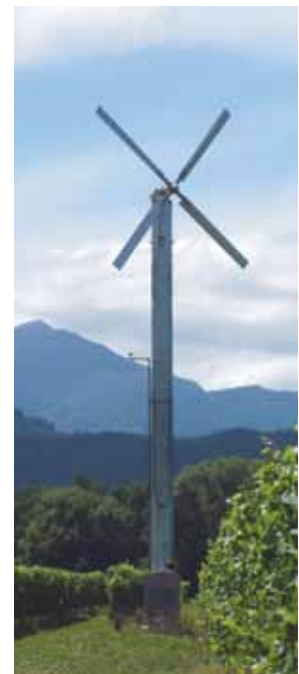
Frost protection fan
