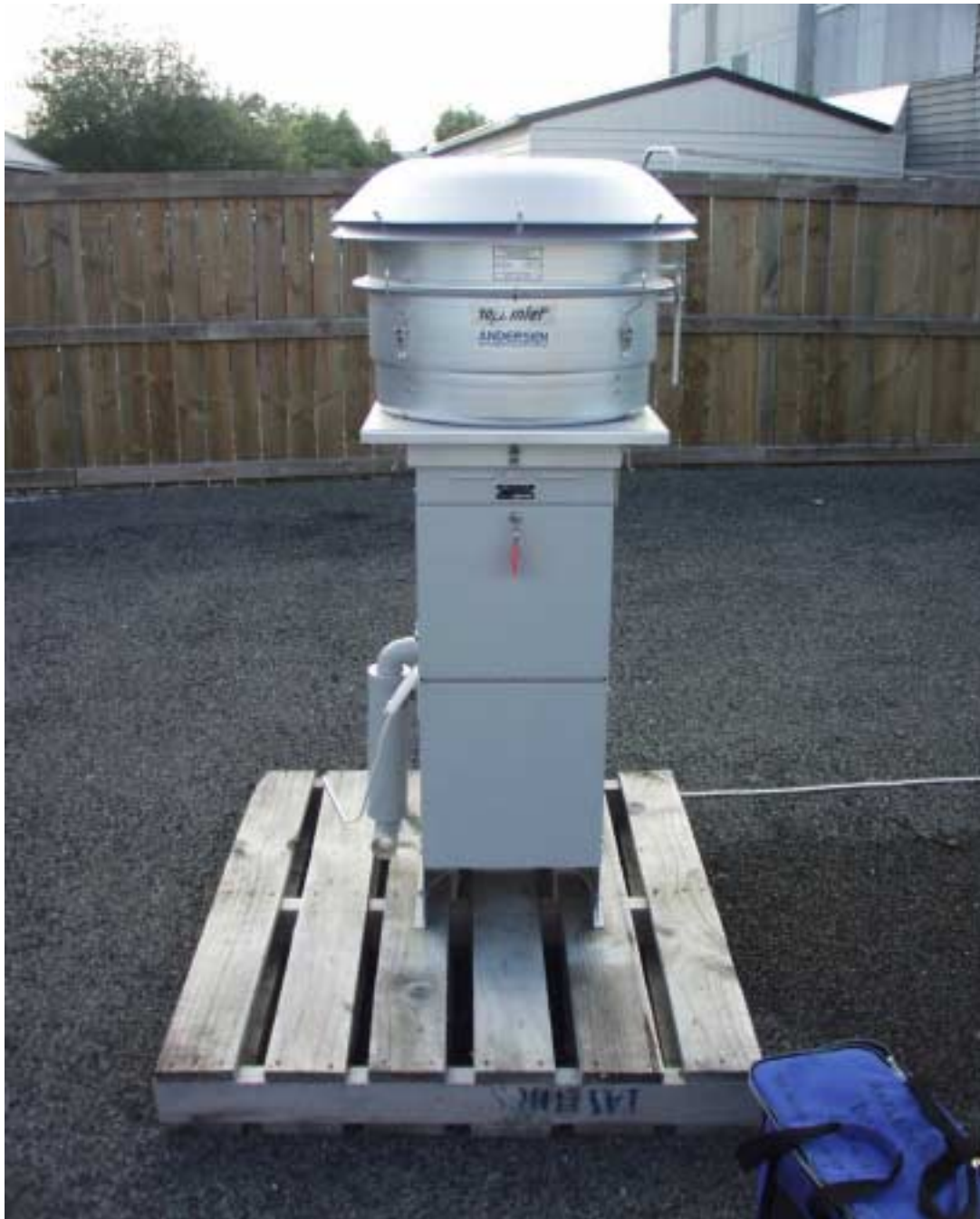
Figure 2: HiVol PM 10 Sampler
